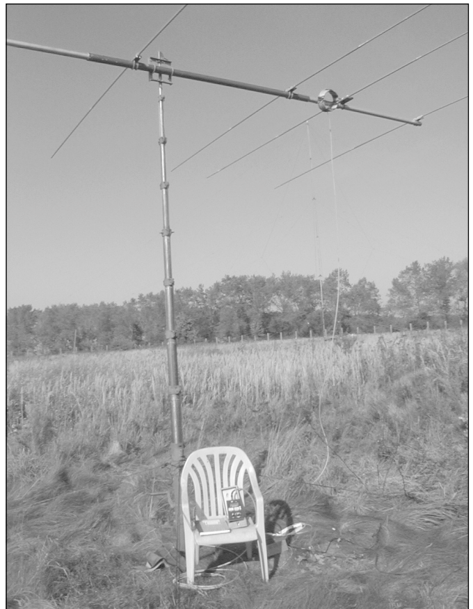
Měřicí pracoviště s anténou 6el. OWA na 28 MHz na výsuvném stožáru Magirus a MFJ-259B.
